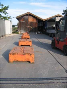
Neue Eichung der Waage durch das Eichamt Traunstein
