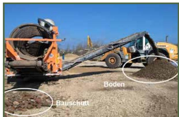
*Bild 3: Durch mobile Aufbereitungsanlagen, in der Praxis zumeist Siebtechnik, können Fremdbestandteile separiert werden.*
