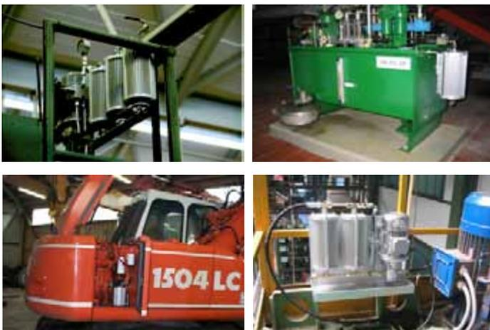
**Radiale und axiale Filterung.** Optimale Nutzung des gesamten Filtereinsatzes. Die Ausfilterung von Nanopartikeln ist so wirksam, dass die Öle höheren Reinheitsklassen zugeordnet werden können, als handelsübliche Frischöle.
